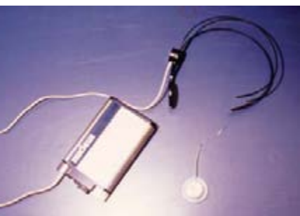
Sprachprozessor, Implantat und Headset – Modell 1984
