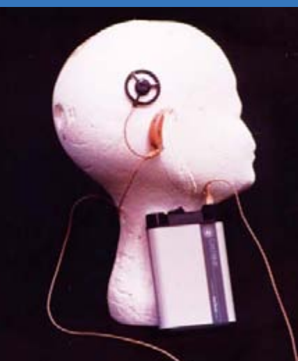
SP, Implantat und Headset – Modell 1984 – mit Magnet
