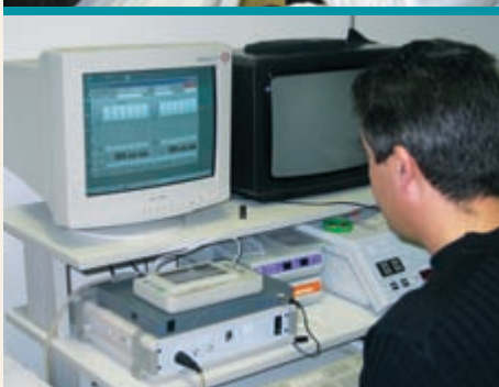
Anschließend werden die Daten aus dem Elektroaudiometer ausgelesen und in den PC importiert; die Daten können dann ausgedruckt oder weiterverarbeitet werden.
