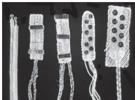
Abb. 1: Vier historische Generationen von Elektroden zur Implantation auf der Oberfläche des Hirnstamms in Höhe des Nucleus cochlearis. Links das erste Implantat mit zwei Kugelelektroden (1979), das zweite, bestehend aus einem Dacronnetz und zwei Streifenelektroden (1981), 8-Kanal-Implantate (bis 2000).
