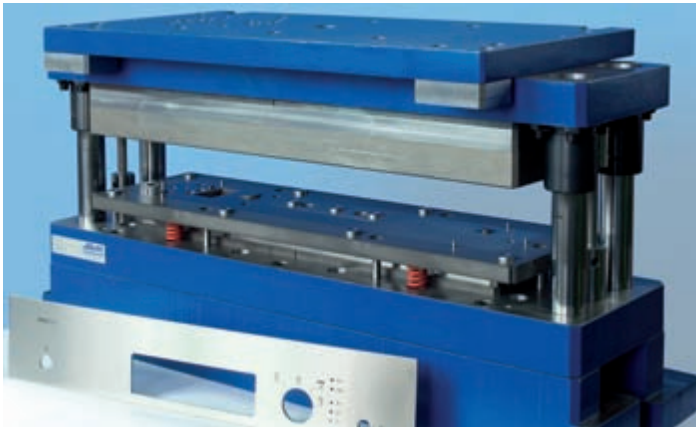
Ziehwerkzeug zur Herstellung von Spülmaschinen-Zierblenden
