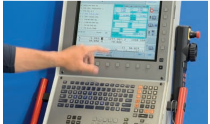
Bedienpult eines 5-Achs-Bearbeitungszentrums
