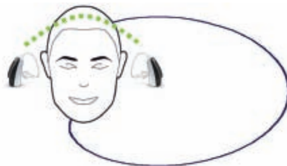
Abb. 1: Richtmikrofontechnik mit verschiebbarem Fokus: Das Eingangssignal der dem Nutzsprache zugewandten Seite wird per Funk auf das andere Hörgerät übertragen. (Quelle: Phonak)
