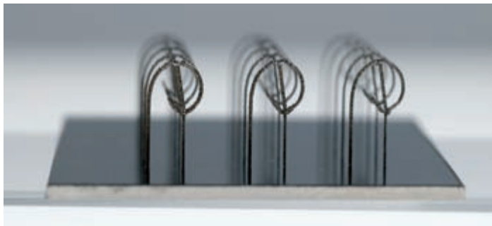
Prototypen der Mikro-Aktoren für das CI, Materialstärke ca. 100 µm
