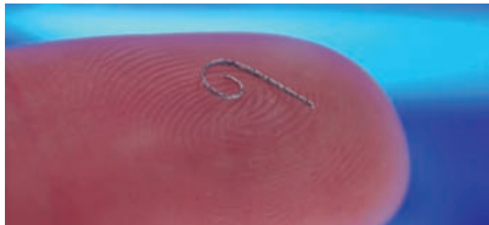
Prototyp der Mikro-Aktoren für das CI im Größenvergleich
