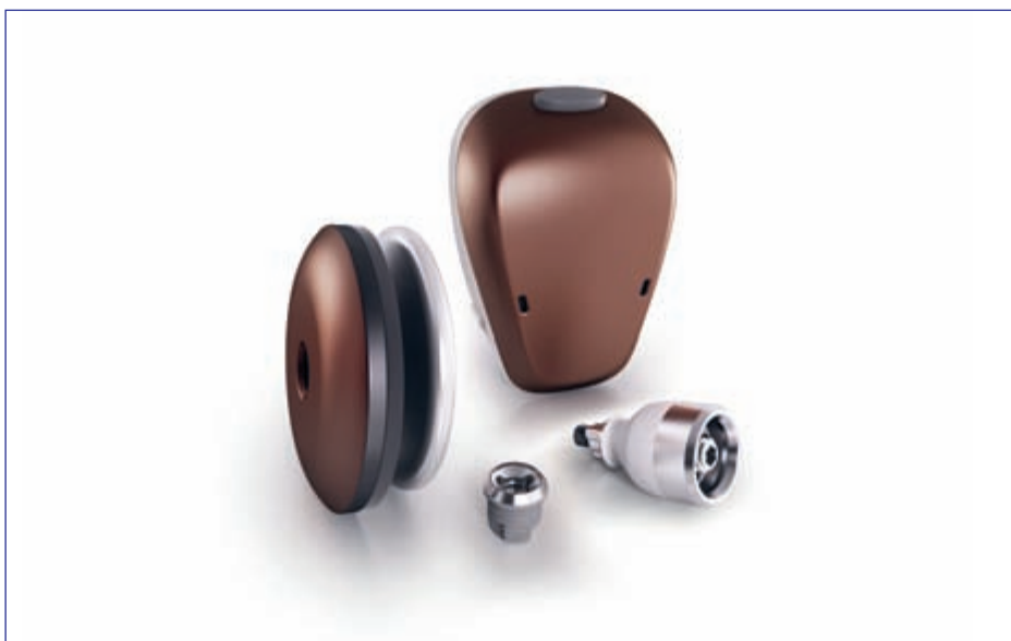
Abbildung 2: Einige Teile aktueller Knochenverankerter Hörhilfen im Größenvergleich. Oben rechts: der von aussen sichtbare CI-Prozessor (Höhe 2.8 cm). Unten rechts: Implantat und Aufsatz (Abutment), welche im Gebrauch miteinander verschraubt sind. Links: äussere und implantierbare Magnetplatten für eine Übertragung durch die intakte Haut.
