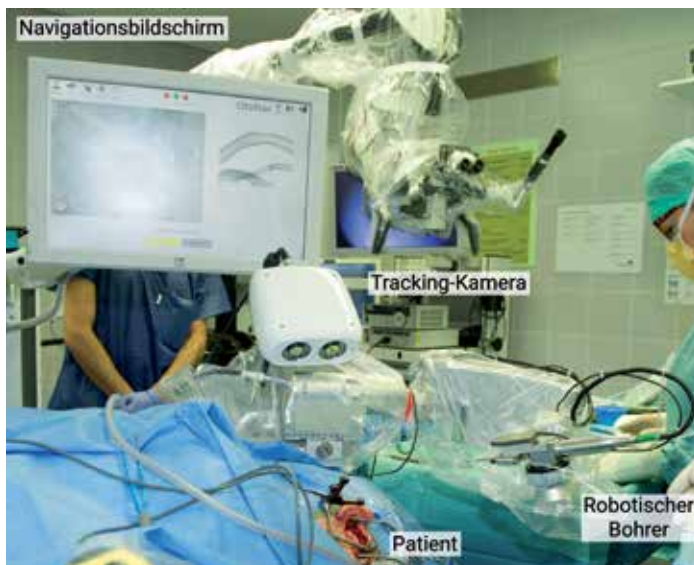
Abb. 1: Das System zur roboterassistierten Cochlea-Implantation im Einsatz am Operationstisch. Foto: Inselspital Bern
